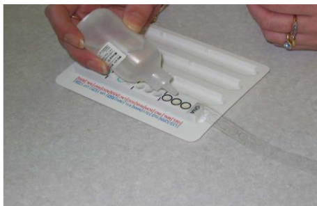
Anaerobik testler için mineral yağ ilavesi
